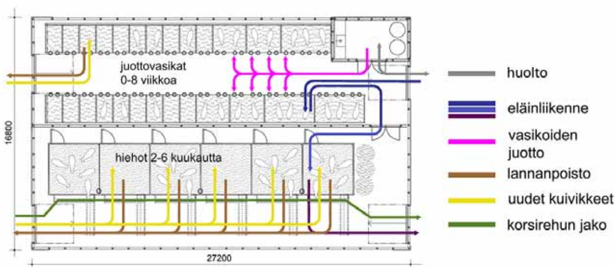
Kuva 18. Vaihtoehtoinen vasikkatalomalli, jossa osastot ovat vierekkäin, jolloin rakennuksen runkosyvyys kasvaa ja pituus lyhenee.
