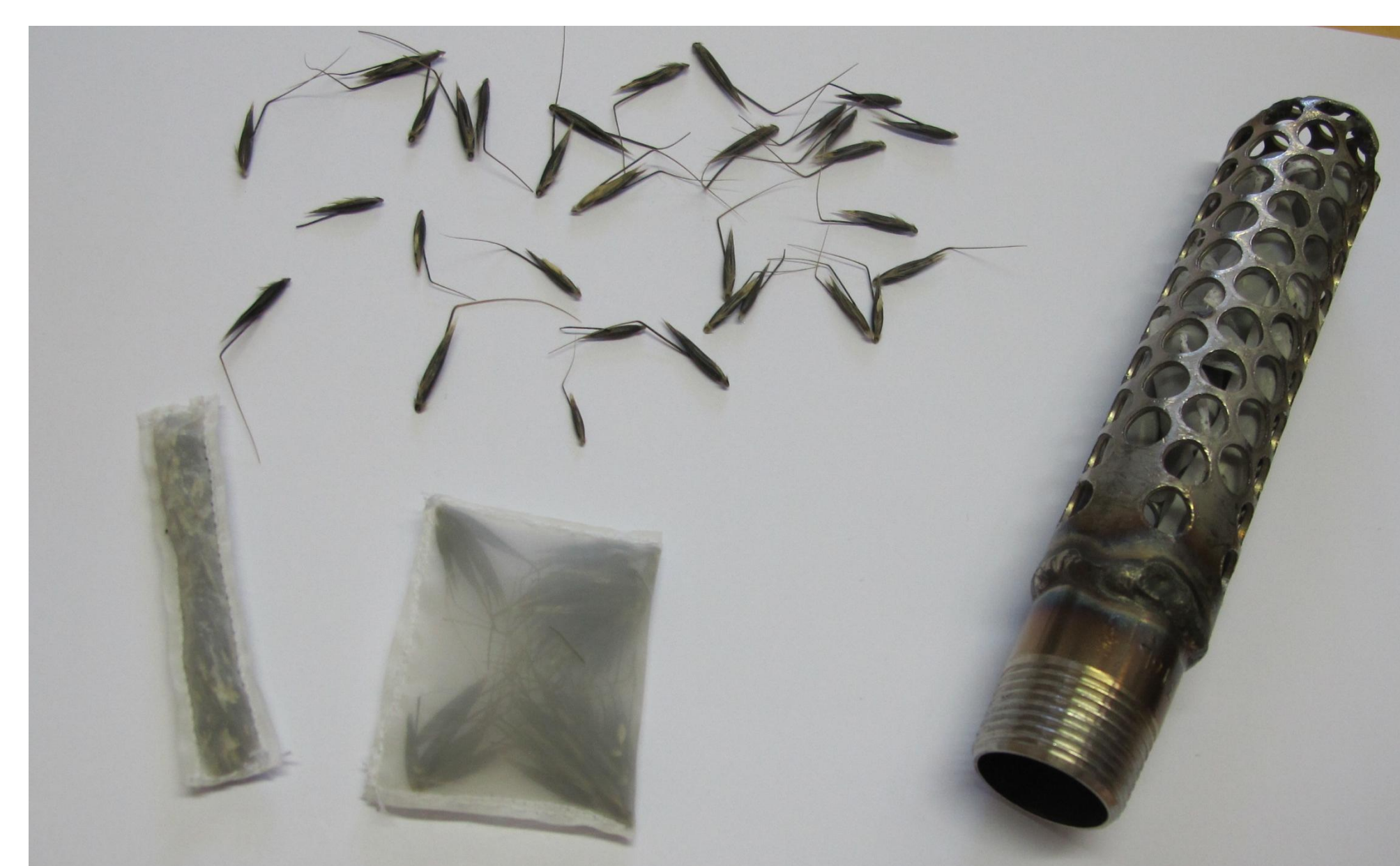
Kuva 2. Hukkakauran siemenet sekä putki, minkä avulla siemenet syötettiin reaktoriin.
