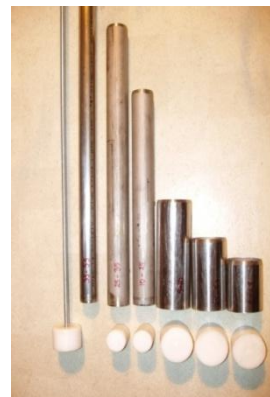
Kuva 3. Suunnitelma, kairaputket, ertacetal- polyasetaalimännät ja kierretanko
