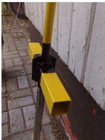
Kuva 6. Kairan alapään vahvistus lattaraudalla
