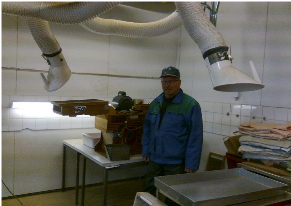
Kuva 2. Plantan lajittelutilan kulmaus (Clipper-lajittelija) ja pölynpoistoputket. Tutkimusmestari K. Kyläsorri koneen ääressä.
