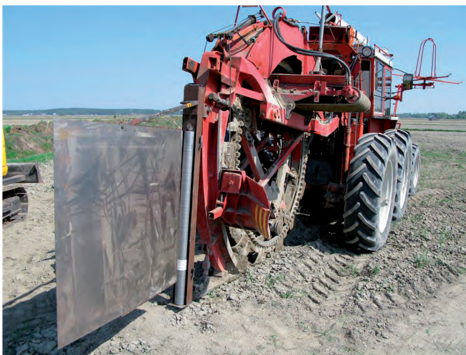
Bild 14. Uppe till vänster installation av plastfilm ner till 1,8 m djup. Uppe till höger fylls fåran igen med sur grävmasa och till sist sprids det avlägsnade plogskiktets jord ut igen. På så sätt undviker man att sura grävmassor blandas med plogskiktet. Nedan täckdiktningmaskin utrustad med monteringsenhet. (Bilder: Rainer Rosendahl)
