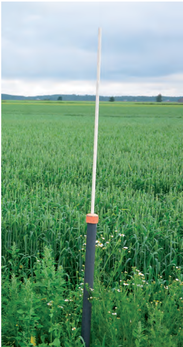
Bild 10. Till vänster ett grundvattenrör med sin flytande antenn som visar grundvattnets avstånd från markytan (Bild: Rainer Rosendahl). Till höger principskiss för grundvattenrör (Källa: Paasonen-Kivekäs 2009).
