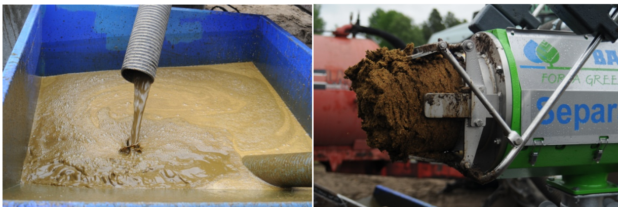
Kuva 14. Biokaasulaitoksen käsittelyjännöksen separointia ruuvikuivaimella. Kuvaaja Perttu Virkajärvi, MTT.
