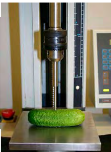
Kuva 15. Kurkun hedelmien kiinteyttä mitattiin Lloyd-laitteella, jonka mittauspuikko oli säädetty etenemään hedelmään 15 mm:n syvyyteen nopeudella 10 mm/min. Kuva: Terhi Suojala-Ahlfors.
