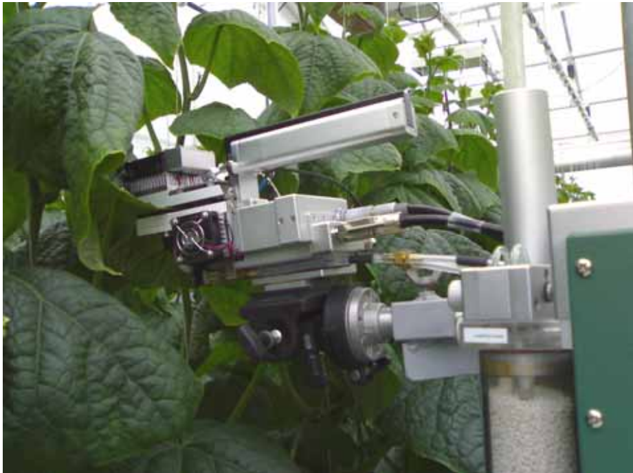
Kuva 4. Fotosynteesimittari työssään. Kurkun lehti on sijoitettu mittauskyvetin leukojen väliin. Mittauskyvetin valaistusta, ilman CO 2 -pitoisuutta, kosteutta ja lämpötilaa voidaan säätää. Mittauspää sisältää myös kaksi infrapuna-analysointia, jotka mittaavat kyvetiin sisään menevän ja sieltä ulos tulevan ilman CO 2 -pitoisuuden ja kosteuden. Etualalla vihreä mittariyksikkö, joka sisältää mm. ilman virtausta säätelevän pumpun. (kuvaaja: Eeva-Maria Luomala)
