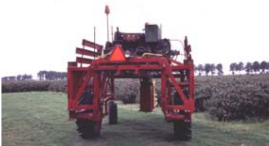
Kuva 1. Herukan keskileikkauksen suunniteltu kone kuvattuna takaapäin. Keski-leikkauksen tekevät terät ovat koneen edessä olevassa leikkauspäässä. (Kuva: Marjo Marttinen)
