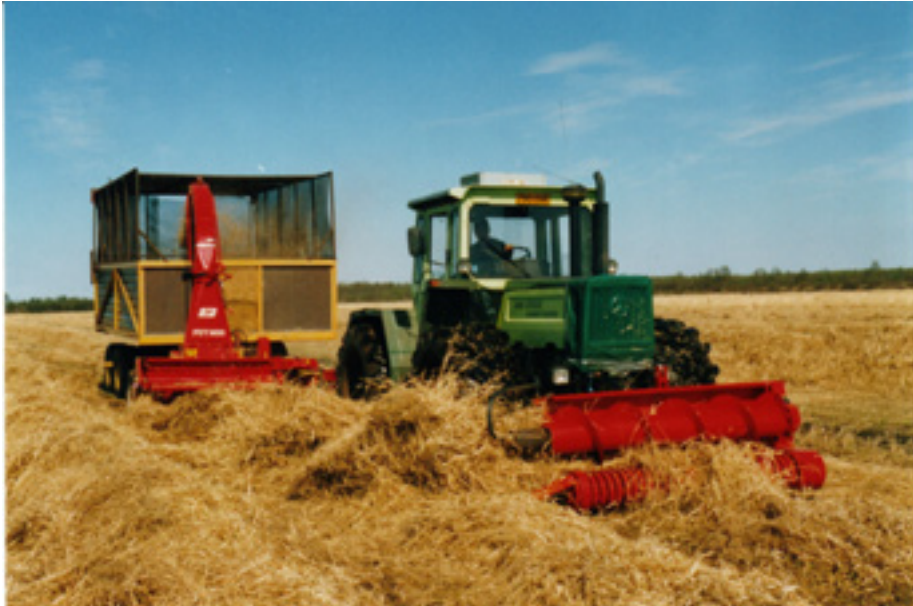
Bild 5. Skörd av rörflen i maj 1997 med exakthack från en hopslagen sträng gjord med frontmonterad strängläggare. Skördeområdet är beläget på Vapo Oy:s Hirvineva som inte längre används för torvupptagning (Lindh m.fl. 2001). (Bild: VTT Energi)
