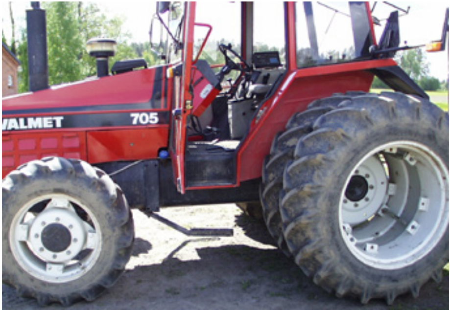
Kuva 26. Valmet 705:n oviaukon alaosan muoto on traktorille hyvin tyypillinen.
