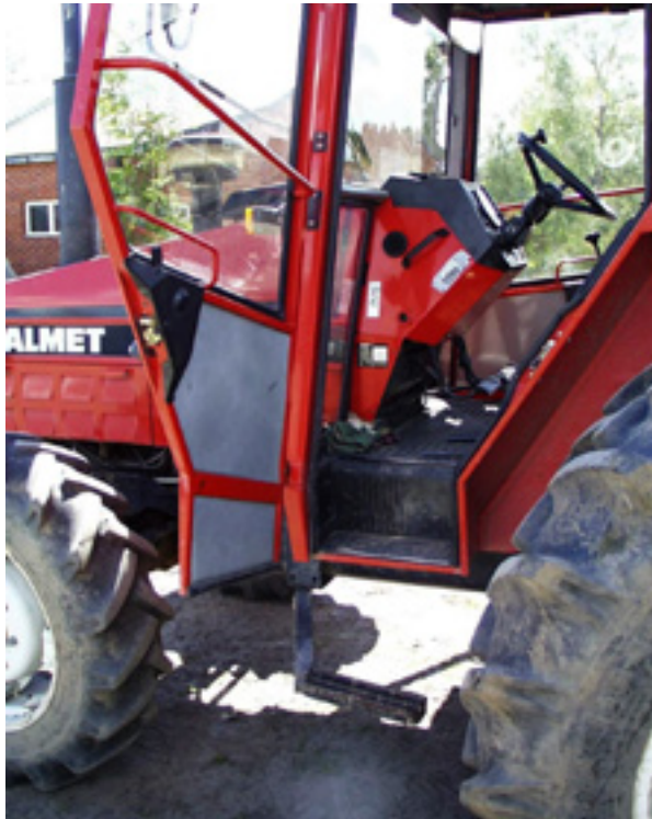
Kuva 23. Valmet 705:ssä on käytetty oviaukon sisäpuolella olevaa porrasta.
