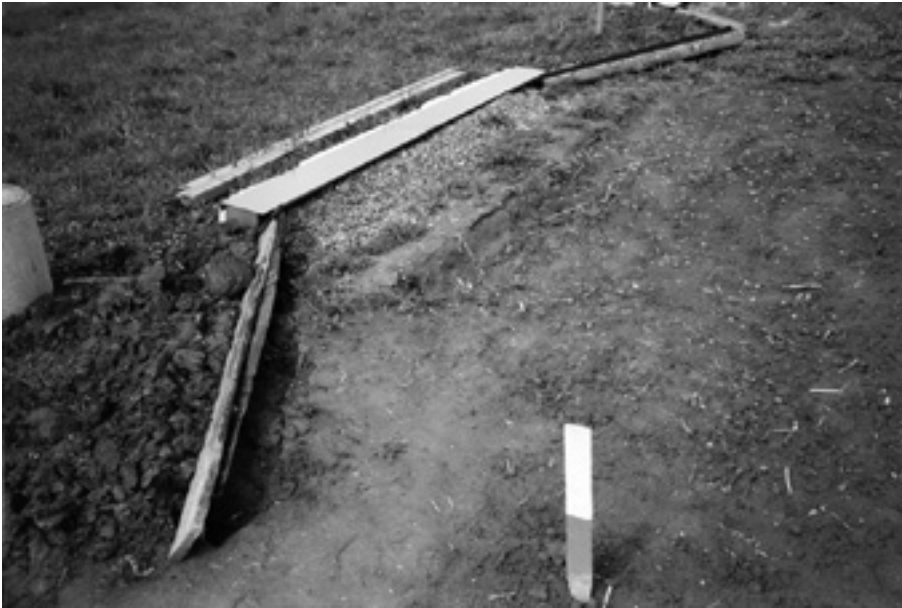
Kuva 2. Pintavalunta johdettiin koko ruudun alalta (6 m x 70 m) kolme metriä leveään keräimeen. Kuva on vuodelta 1995. (Kuva: Jaana Uusi-Kämpä)
