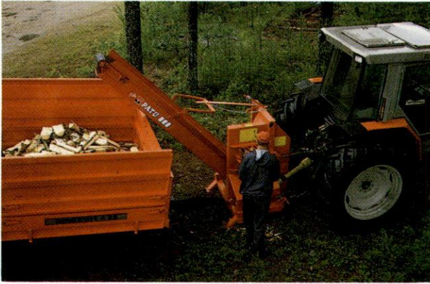
Kuva 7. Katkaisu-halkaisukone, jossa sama terä ensin halkaisee ja sitten katkaisee puun.
