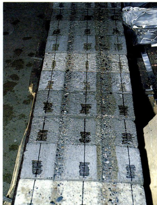
Kuva 8. Kulutuskävyyskokeen kulutusuria erilaisissa betoneissa, vasemmalla mekaanisen kulutuksen ura ja oikealla mekaaniskemiallisen kulutuksen ura. Figure 8. Different kinds of concretes with grooves from testing resistance to abrasion, on the left grooves from mechanical stress and on the right grooves from both mechanical and chemical stress.
