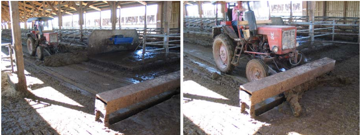
Kuva 18. Lannanpoisto tapahtui yleisimmin traktorilla tai pienkuormaajalla, jonka työntölevyllä lanta kerättiin hallin keskialueella sijaitsevaan pudotusluukkuun. Lantaa kierrätettiin keskikanaalissa jäätymisen estämiseksi ja samalla pumpattiin varsinaiseen lantavarastoon.
