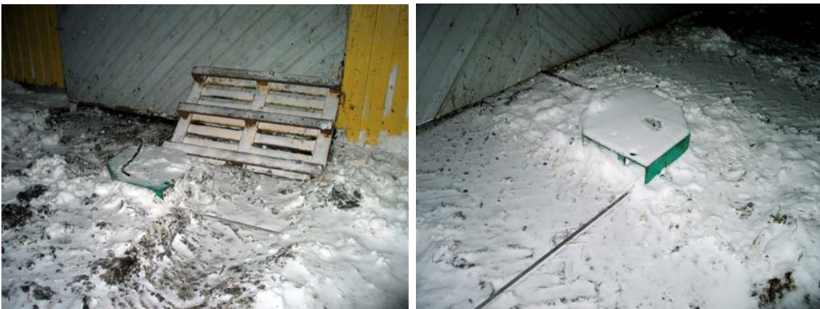
Kuva 21. Lannanpoistossa esiintyi ongelmia sellaisilla tiloilla, joissa lannanpoisto perustui pelkääntään raappaan. Ongelmat aiheutuivat esimerkiksi rakennuksen ulkopuolelle sijoitetuista vaijerien kääntöpyöristä, jotka jäätyivät pakkasessa. Kuvista näkee, että raappojen jumiuduttua lantakäytävälle on jouduttu ajamaan traktorilla tyhjennystä varten.
