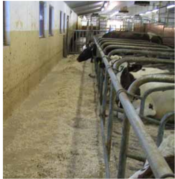
Kuvat 133 ja 134. Tarkkailukäytävät lisäävät tilan tarvetta, mutta voivat monikäyttöisiksi suunniteltuina tehdä tilaratkaisusta toimivamman. Kuvat Tuomo Linnakallio ja Kristiina Hakkarainen.
