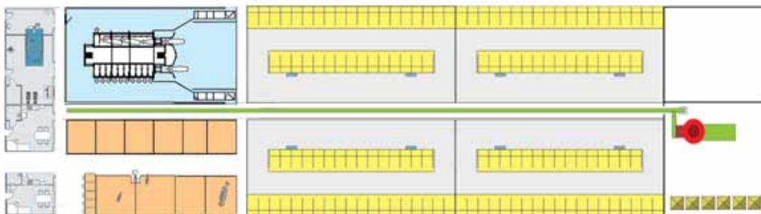
Kuva 166. 136 parsipaikan pihatto, jossa ruokinta toteutettu mattoruokkijalla. Lypsyasema on sijoitettu sivulle ja poikima-, vasikka- ja sairasmaikat yhteen osastoon. Kuva Tapani Kivinen.
