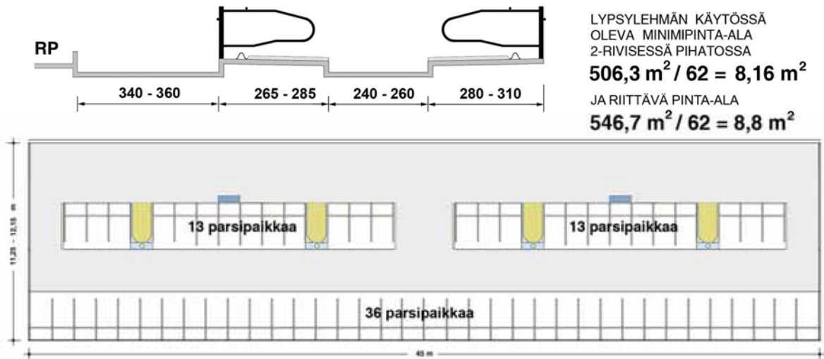
Kuva 148. Suositeltavat käytäväleveydet 2-rivisessä osastoratkaisussa. Parsipaikkoja on yhteensä 66 kpl, joista 4 on varattu väkirehuautomaateille (1/15 mitoitus). Tällöin lehmille on 62 parsipaikkaa. Lypsylehmän vapaasti käytettävissä oleva pinta-ala on vähintään 8,16 m 2 . Riittävä pinta-ala on 8,8 m 2 . Osaston syvyysmitta ulkoseinästä ruokintapöydän reunaan on minimissään 11,25 m ja reilu eli riittävä mitta on 12,15 m. Osaston pituusmitta on 45 m. Kuva Tapani Kivinen.
