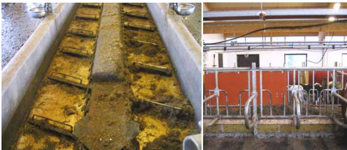
Kuvat 144 ja 145. Ketjuruokkija (vasemalla) tai nauharuokkija (oikealla) yhdistettynä syöttöparsiin (oikealla) mahdollistavat useat rehun jakokerrat ja riittävän rehun saannin. Kuvat Kristiina Hakkarainen ja Janne Karttunen.
