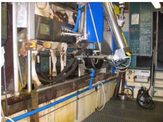
Kuvat 103 ja 104. Lypsyrobottiloilla päivittäinen eläintä kohti laskettu työaika oli pienin, mutta myös robottilojen välillä oli suurta vaihtelua karjanhoidon työnmenekissä. Tarkkailua, huoltoa ja puhdistusta helpottavaa lypsisyvennystä, kuten vasemmassa kuvassa, voidaan suositella lypsyrobottiloille. Hälytyksiä robottiloilla sattui keskimäärin 4 kpl kuukaudessa (vaihtelu 0,5–10 kpl/kk). Oikean kuvan väkirehuautomaatissa oleva takaportti ulottuu riittävän alas, jotta se suojaa lehmän takapäätä hyvin häirintäryityksiltä. Ilman takaporttia lähes jokainen ruokailukerta kärsii häirinnästä. Väki-rehuautomaatteihin oltiin yleisesti tyytyväisiä. Kuvat Mari Korkiakangas ja Tuomo Linnakallio.
