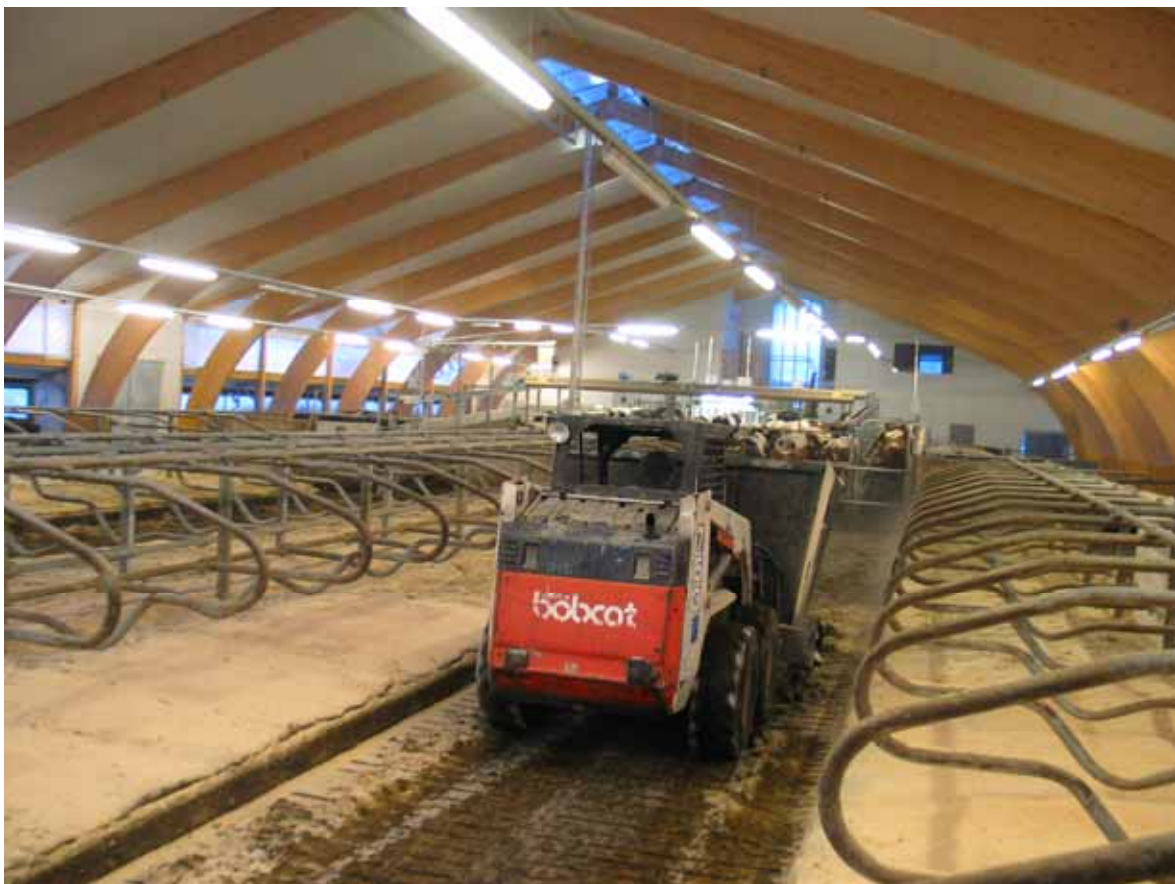
Kuva 50. Parsien kuivitusta Bobcatilla ja sahapurulla. Työ käy nopeasti ja vaivatta, mutta levitysvaiheessa puupölyä esiintyy tuntuvia määriä. Kuva Tapani Kivinen.
