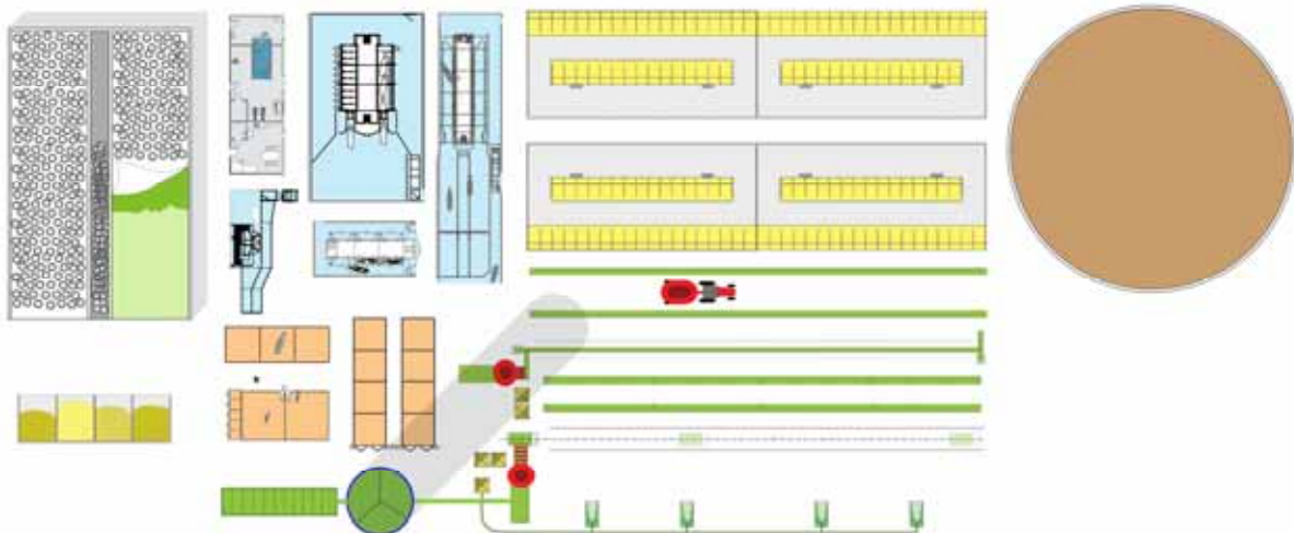
Kuva 164. Esimerkki pihatton toiminnallisista tilaryhmistä ja tekniikkaratkaisuksista samassa mittakaavassa ”tarjottimella”. Kotioloissa pihattosuunnittelua voi tehdä ilman tietokonettakin piirtämällä tilamoduuleita sopivaan mittakaavaan (esimerkiksi 1:200) ja leikkaamalla ne paperista. Tämän jälkeen paperimoduuleita sijoitellaan toistensa suhteen muodostamaan oikein toimivia pihattoratkaisuvaihtoehtoja. Kuva Tapani Kivinen.
