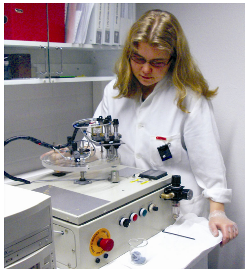
Kuva 8. Radiokemiallista menetelmää voidaan käyttää esimerkiksi maatalouden pintojen puhdistuvuutta tutkittaessa, mutta tämä agroteknologian laitoksen erityisosaaminen soveltuu monenlaisiin muihinkin kohteisiin. Kuva: Eija Pesonen-Leinonen.
