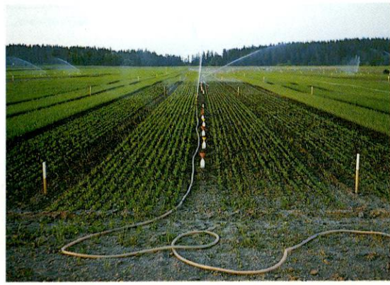
Kuva B. Sadetuksen tasaisuutta ja vesimäärää seurattiin mittaamalla pulloihin kertyvää veden määrää sadetuksen aikana 2. 6. 1980.
