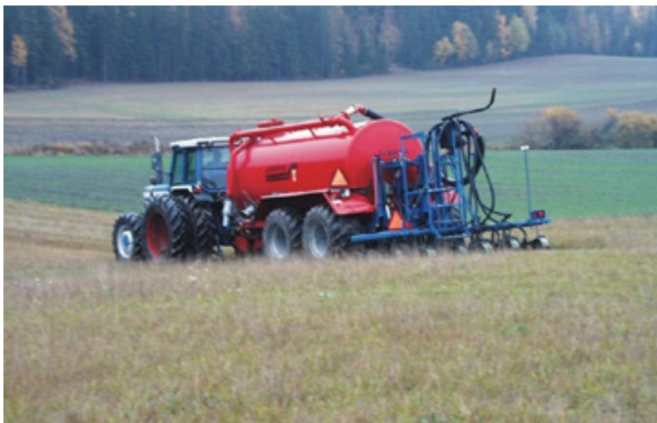
Tutkimusyksikössä kehitetyn laitteiston avulla tutkitaan nurmien sijoituslannoitusta. Tavoitteena on ympäristöhaittojen vähentäminen menetelmän avulla. Kuva: Petri Kapuinen.
