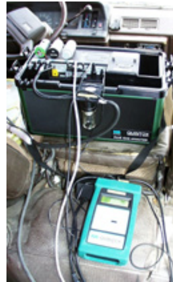
Savupeittauksen aikana seurattiin kuivuriin johdetun savukaasun CO-, CO 2 - ja O 2 -pitoisuuksia. Kuva: Merja Paasonen.
