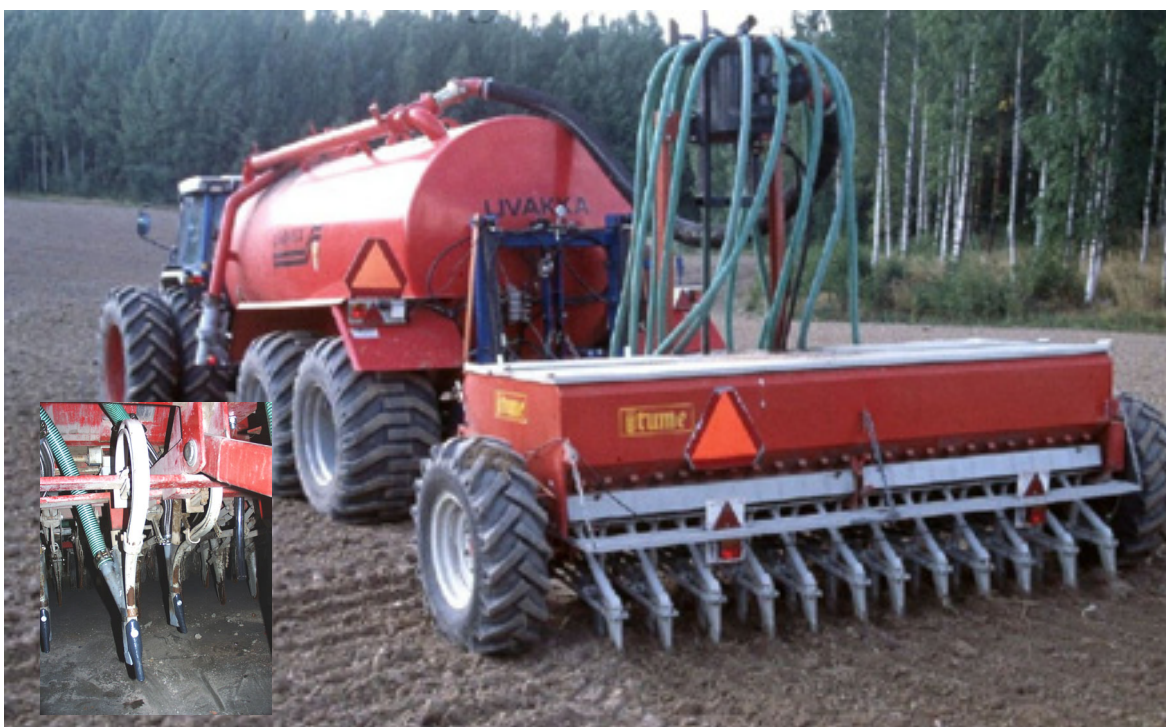
Kylvön yhdistettyyn lietelannan sijoitukseen soveltuva laitteisto. Kuva: Petri Kapuinen.
