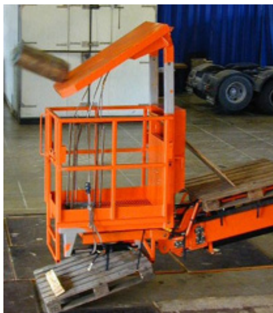
Turvakatoksen lujuuskoe (FOPS), jossa tarkastetaan kuljettajan suojaus putoavilta esineiltä. Pudotuskappaleen massa 230 kg ja pudotuskorkeus 5,19 m. Kuva: Kari Maunula.
