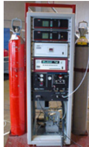
Vakolan pakokaasupäästömittauslaitteiston kaasuanalysaattorit. Kuva: Esa Elonen.
