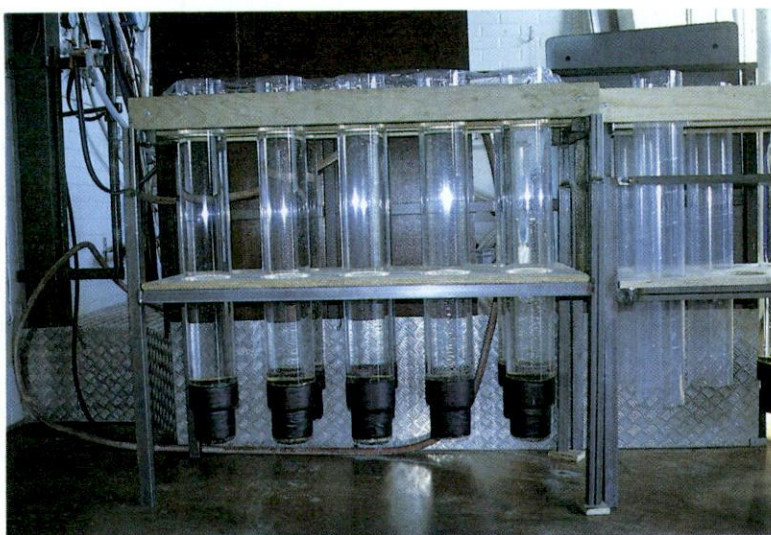
Kuva 1. Betonien tiiviyyden tutkimiseen käytetyn akryyliputkikokeen järjestely
