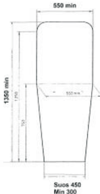
Kuva 10. Puimurit: Oven ja kulkutien mitat, ISO 4254-7:1995, kuva 3.
