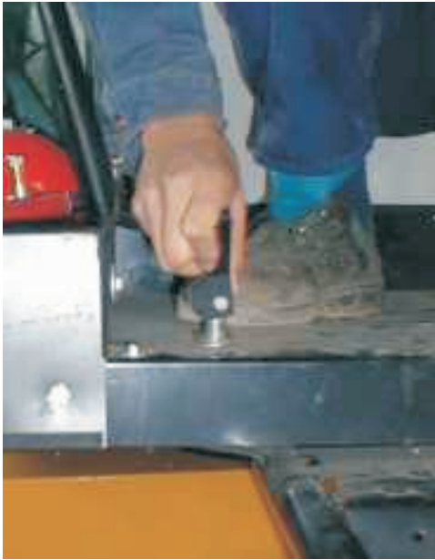
Kuva 22. Käännettävän, tikasmallisen rapun lukitustappi on vaikea saada osumaan kohdalleen, koska lukittumiskohtaa ei näe eikä lukittumiskohta ole ääriasento.
