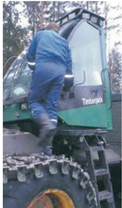
Kuva 32. Iso ovi aiheuttaa sen, että rapulta joutuu ovea avattaessa siirtymään sivuun. Oveissa oleva peilinvarsi toimii hyvänä kädensijana, vaikka koneessa on muutenkin paljon kädensijoja.
