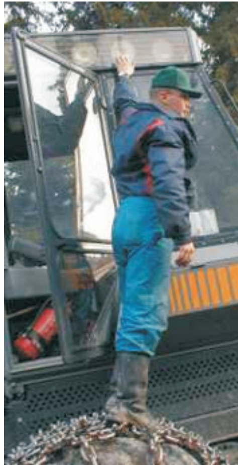
Kuva 34. Joihinkin huoltokohteisiin on vaikea ulottua. Jos huoltotasoa ei ole mahdollista asentaa, huoltokohde pitäisi suunnitella niin, että kurottumisaika on lyhyt eikä ole pelkoa esim. osien tippumisesta.
