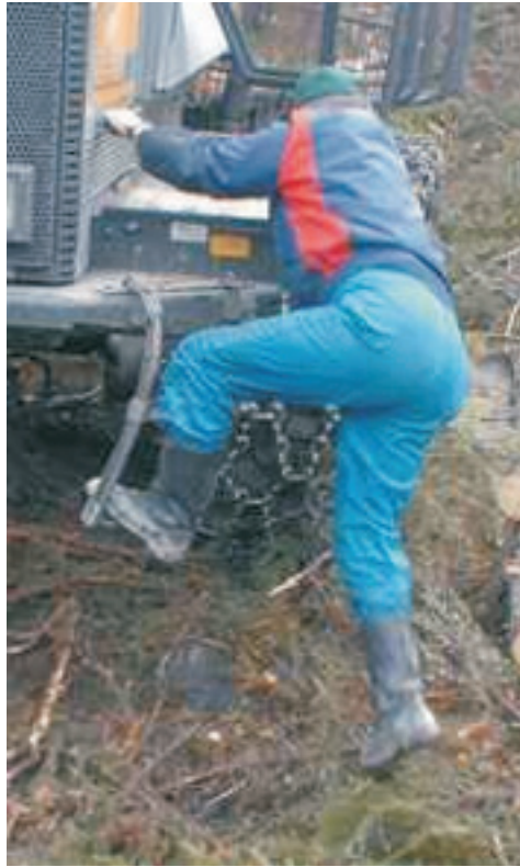
Kuva 23. Epätasaisen maaston johdosta alin askelma on tavanomaista ylempänä. Sisäänpäinjoustava askelma ja alhaalla oleva kädensija aiheuttavat koneeseen noustessa suuren voimantarpeen.
