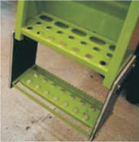
Kuva 24. Alin askelma joustaa kohtuullisesti sivusuunnassa leveiden kumikaistaleiden ansiosta. Alimman askelman reunassa on hammasrauta, seuraava askelma on jo reunastaan pyöreä.
