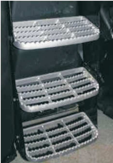
Kuva 25. Hammaspintaisten valuprofiilien käyttö askelmina.
