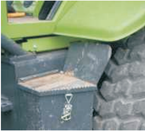
Kuva 27. Askelma on suojattu sekä lokasuojalla että erillisellä lisälevyllä, jonka ylin osa kurasta tosin pääsee suoraan. Ylin askelma muodostaa työkalulaatikon kannen. Se on umpinainen, joten mahdollinen lika ei pääse valumaan askelman läpi.
