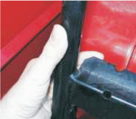
Kuva 31. Astinripojen päihin jää helposti teräviä särmiä, joihin kädet osuvat, kun kättä liu'utetaan johdetta pitkin.
