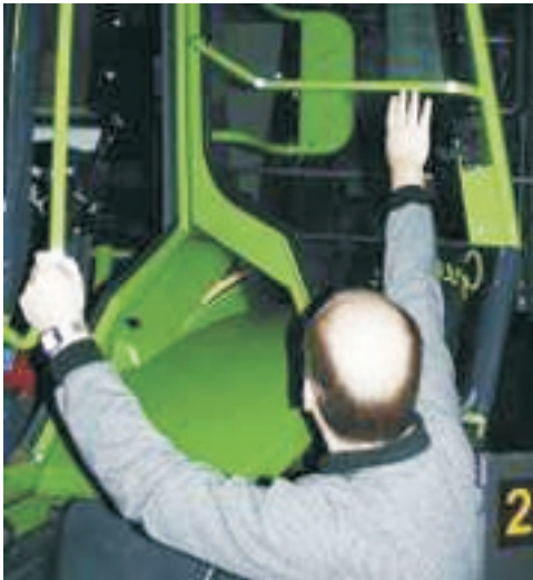
Kuva 28. Ovessa vaakasuorassa oleva kaide on usein liian korkealla, jos siihen halutaan tarttua heti ensimmäiselle rappuselle noustessa.
