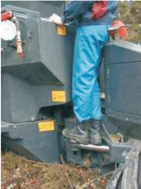
Kuva 17. Huoltotasoilla joudutaan liikkumaan ainakin silloin, kun huoltoja tehdään maastossa.
