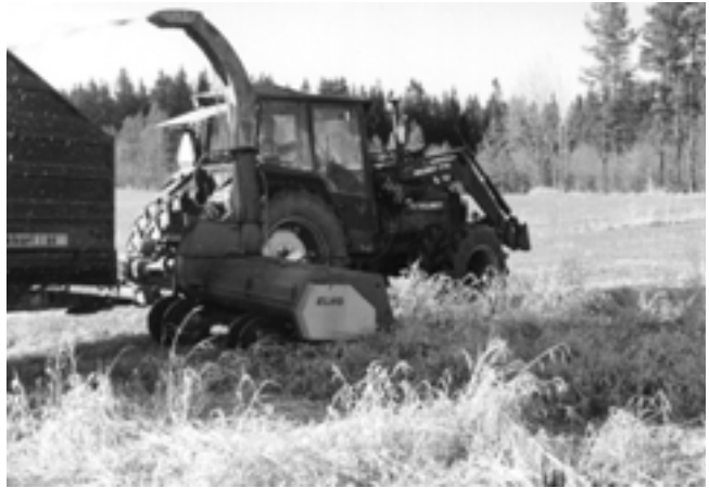
Kuva 12. Korjuu suoraan kasvustosta kaksoissilppurilla Alavudella (kuva: VTT Energia).
