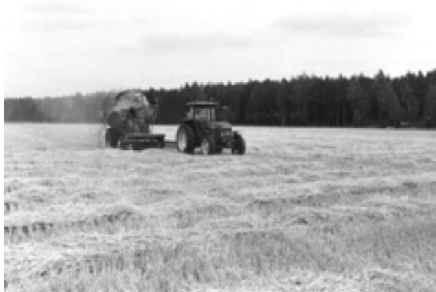
Kuva 3. Oljen irtokorjuukokeis- sa Loimaalla käytössä ollut tarkkuussilppuri-traktori-rehu- peräkärri-yhdistelmä (kuva: VTT Energia).
