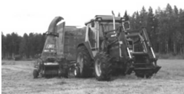
Kuva 6. Alavuden syyskorjuukokeissa käytetty traktori-tarkkuussilppuri-perävaunu-yhdistelmä (kuva: VTT Energia).
