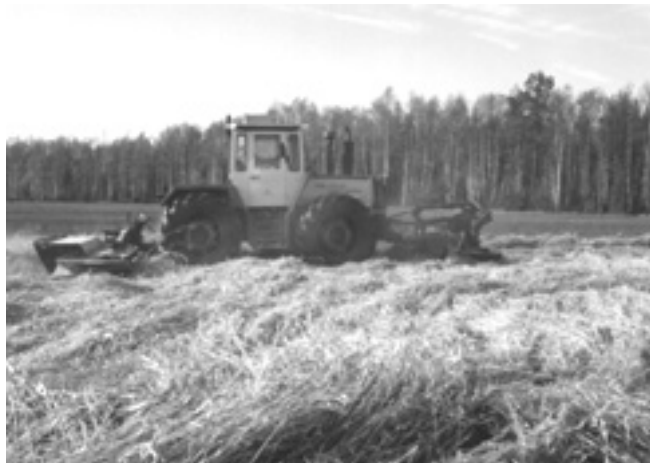
Kuva 14. Etuniitto-takaniittomurskain-yhdistelmä Hirvinevalla keväällä 1997 (kuva: VTT Energia).
