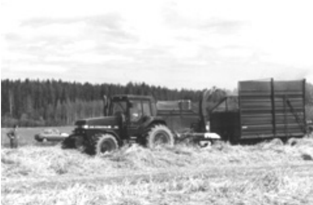
Kuva 10. Tarkkuussilppuri silpuamassa ruokohelpeä karheen tekemältä karheelta Jokioisissa (kuva: VTT Energia).
