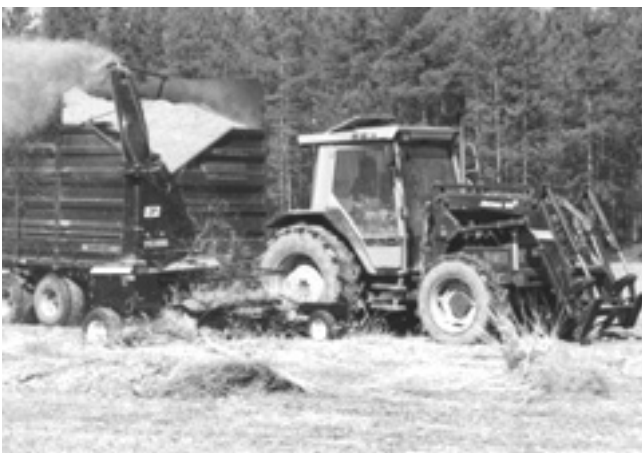
Kuva 11. Korjuu tarkkuussilppurilla lautasniittokoneen niitokselta Alavudella (kuva: VTT Energia).
