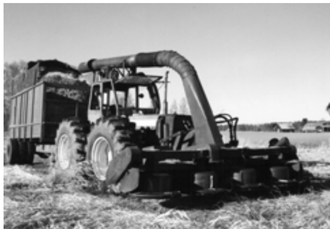
Kuva 13. Hietarannan pajan leveä silppuri korjaamassa ruokohelpeä suoraan kasvustosta (kuva: VTT Energia).
