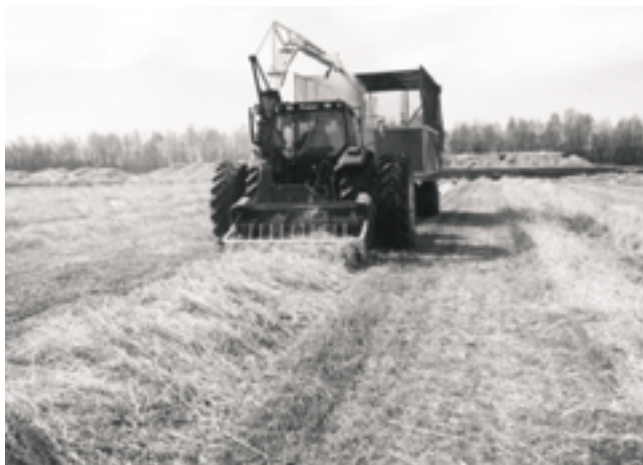
Kuva 17. Noukinpäällä varustettu Kemper-korjuukone silppuamassa perävaunuun erillisen karheen tekemää karheta Hirvinevan korjuukokeissa 1997 (kuva: VTT Energia).
