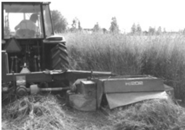
Kuva 5. Alavuden syyskorjuukokeissa käytetty niittomurskain (kuva: VTT Energia).
