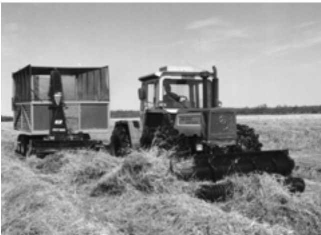
Kuva 16. Etukarheeja-tarkkuussilppuri-perävaunu-yhdistelmä Hirvinevan korjuukoikeissa (kuva: VTT Energia).
