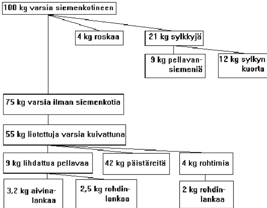
Kuva 13. Miksi pellavatuotteet ovat kalliita? Kaavio osoittaa, että 100 kg:sta pellan varsia saadaan vain 3,2 kg aivinalankaa, 2,5 kg rohdinlankaa sekä 2 kg rohdinlankaa säkkikangasta varten. Raaka-aineen käsittelyhäviöt ovat siten 92,5%. Tämän lisäksi kustannuksia lisäävät monet käsittelyvaiheet jo ennen kuitujen kehruukuntoon saattamista, vaatiin esim. puuvillaan verrattuna paljon enemmän ihmistyövoimaa ja aikaa.
