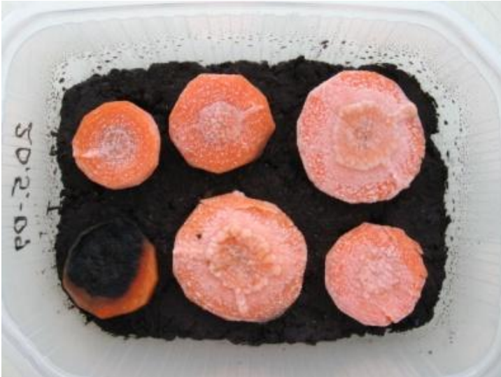
Kuva 1. Porkkananmustamätätetestissä porkkanakiekkvoja testattavan maanäytteen päällä. Yhteen porkkanakiekkoon on kasvanut maasta mustaa taudinaiheuttajaa. Kuva Tuija-Liina Laamanen
