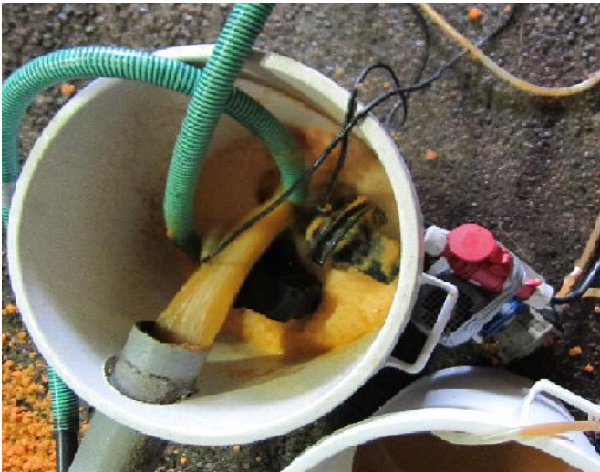
Kuva 30. Kuorimolta tulevat jätevedet erotetaan muista jätevesistä
