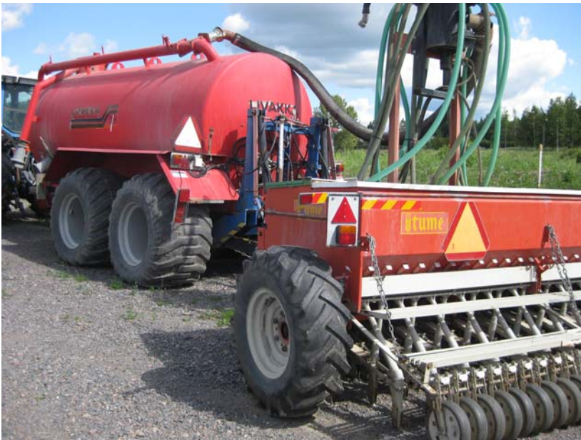
Kuva 6. Biokaasuprosessin liete- ja nestemäisten lopputuotteiden sijoittava levityslaitteisto. Kuva: Teija Paavola, MTT.
