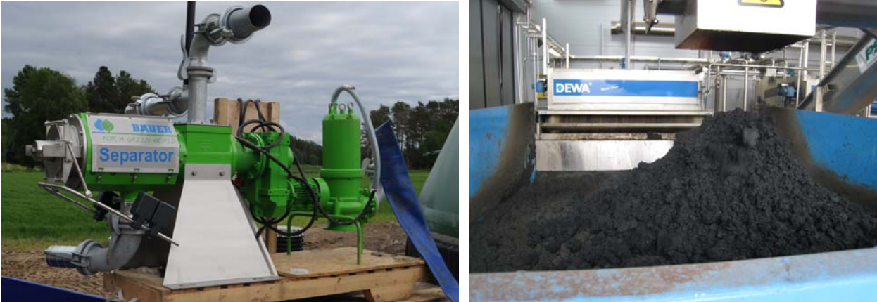
Kuva 20. Oikealla: Lannan erotteluun tarkoitettu ruuvikuivain. Kuva: Perttu Virkajärvi, MTT. Vasemmalla: Suotonauhut Biovakka Suomi Oy:n Topinojan laitoksella. Kuva: Sari Luostarinen, MTT.
