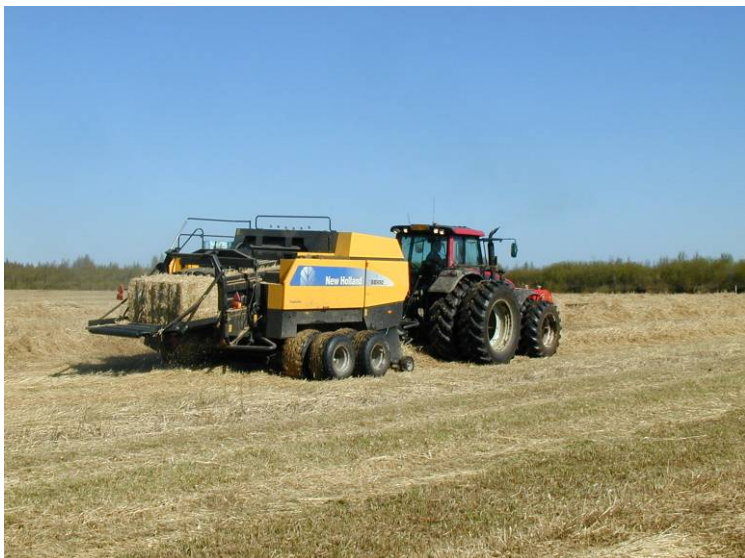
Kuva 2. Ruokohelven tehokasta korjuuta kanttipaalaimella (Kuva: Timo Lötjönen, MTT).
