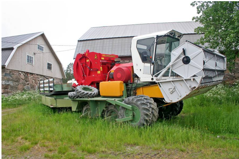
Kuva 4. Järviruo'on korjuuseen Suomessa kehitetty itsekulkeva korjuukone (Kuva: Eija Hagelberg, BSAG).
