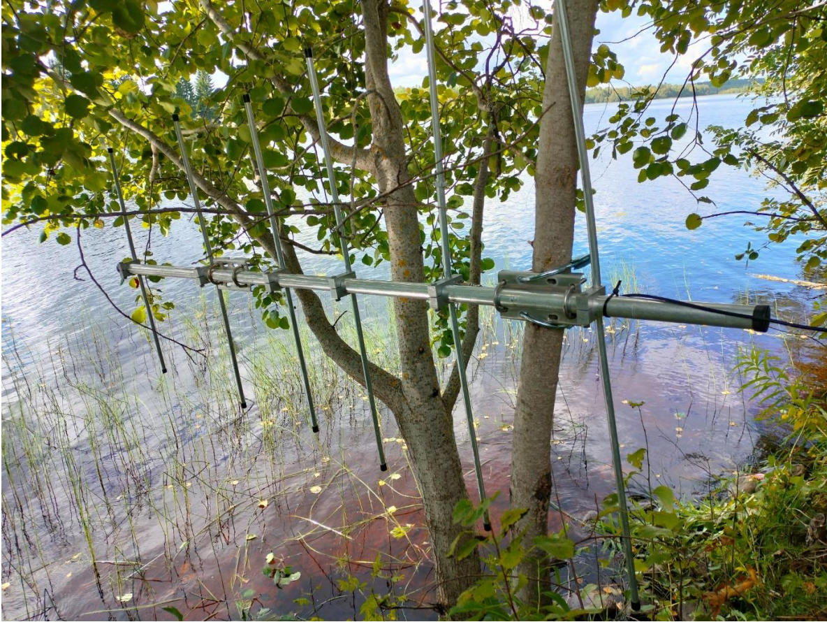
Kuva 5. Kiehimänjoen itärannalle Leppikosken padosta 5 km ylävirtaan Uvan altaan eteläpään asennettu radiolähetinantenni.
