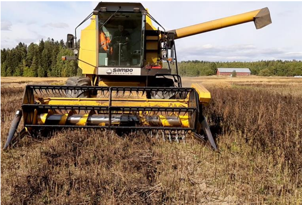
Kuva 13. Kuivuneiden härkäpapukarhojen puinti tavallista leikkaavaa pöytää käyttäen 12.9.2022, joka oli 12 päivää niiton jälkeen. Pöydässä käytettiin laonnostopiikkejä. Kuva: Matts Nysand, Luke.
