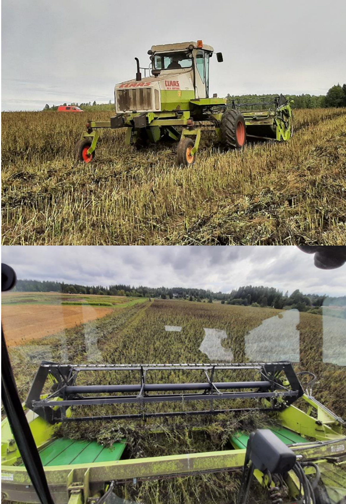
Kuva 11. Härkäpavun niitto ajoniittokonetta käyttäen Luken niittomenetelmävertailussa 31.8.2022. Alakuvassa: Ohjaamosta näkyvän leikkuupöydän vihreä mattokuljetin kerää niitetyn kasvuston karhoksi koneen keskelle. Kuvat: Matts Nysand, Luke.
