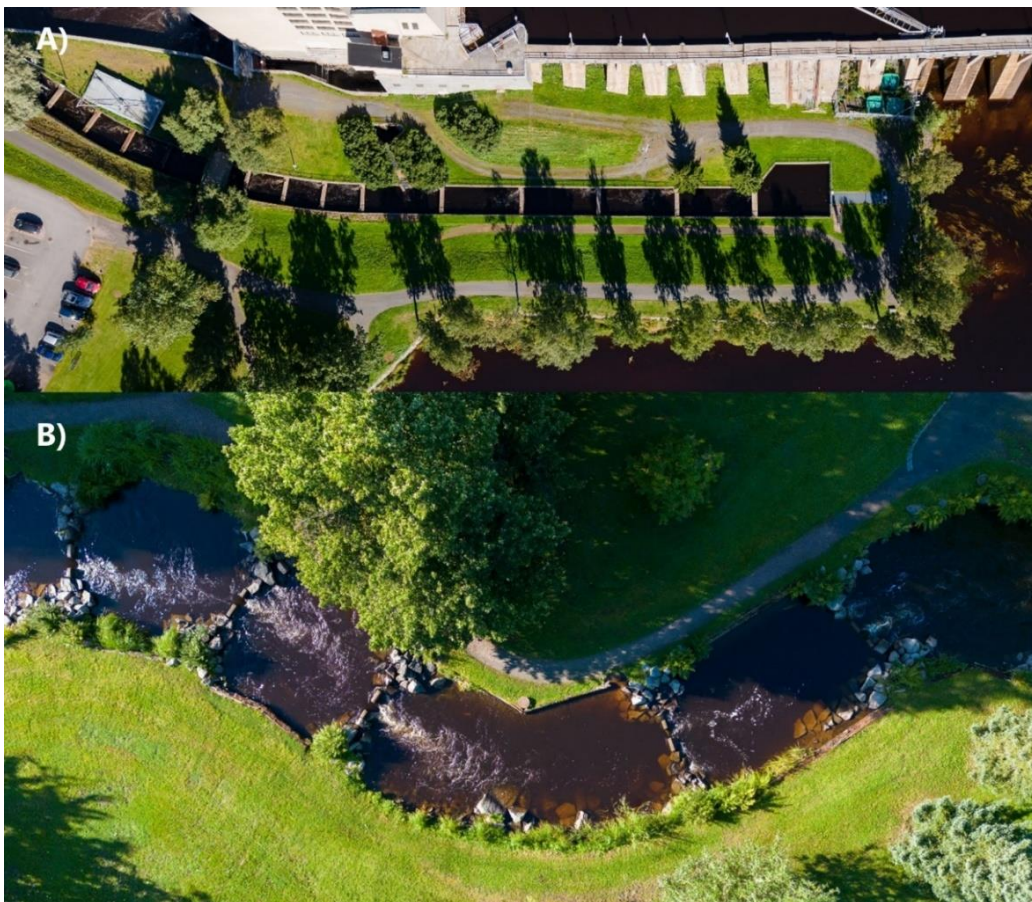
Kuva 2. Merikosken kalatiessä on A) voimalaitoksen vieressä sijaitseva alakalatie, joka mahdollistaa kalojen kulun voimalaitoksen alakanavasta Kauneusaltaaseen, ja B) patosillan vieressä sijaitseva maisemoitu yläkalatie, joka mahdollistaa kalojen kulun säännöstelypadon yläpuolelle. Kuvat: Jari Lindeman, Luke
