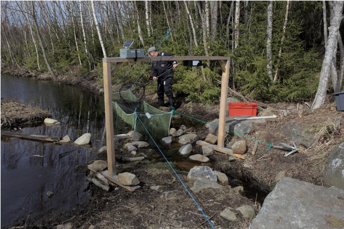
Kuva 2. Kalojen kutunousuun käytetty riistakamera ja akku telineineen. Kameran takana on nousukalojen pyyntiin asetettu rysä. Kuva: Lari Veneranta.
