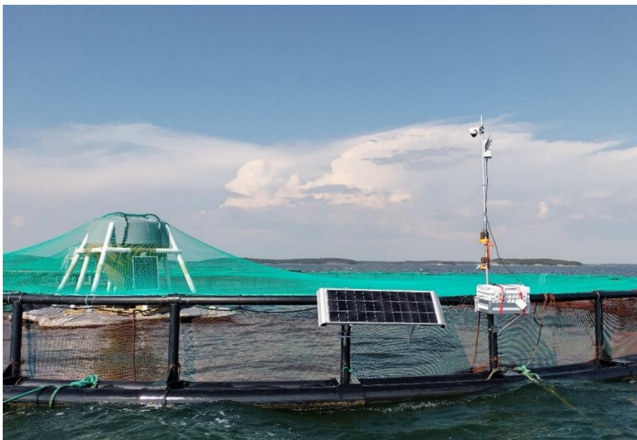
Kuva 12. Valvontakamerajärjestelmä kiinnitettynä raamiin. Kuva: Veera Hauhia.
