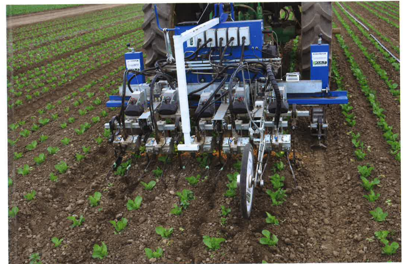
Garford Robocrop "InRow Weeder" använder Robocrop videobildanalysteknik för att lokalisera enskilda växter och mekaniskt ta bort ogräs mellan rader och mellan plantor.
