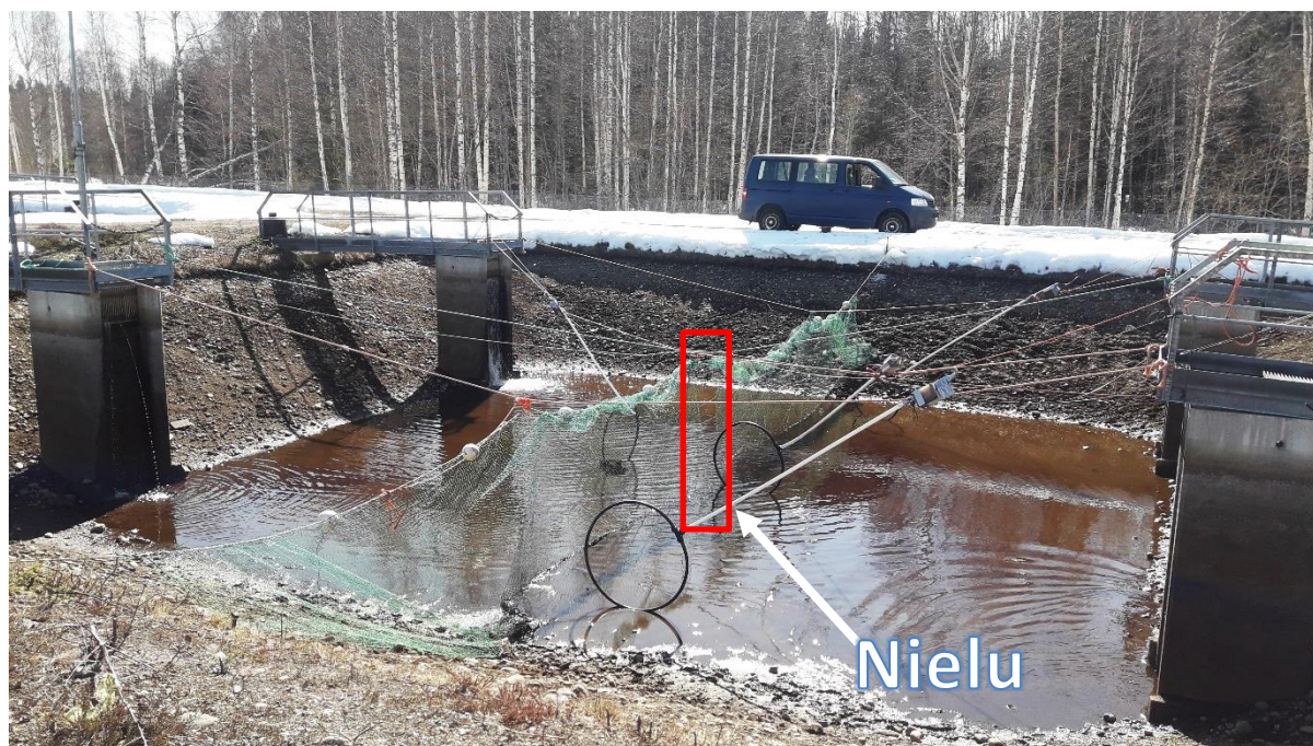
Kuva 2. Huhti-Toukokuun vaihteessa toteutetun esikokeen koeareena, josta vedet lähes kokonaan tyhjennettynä (laitteiden asennuksen helpottamiseksi). Mustat vanteet valkoisilla varsilla (4 kpl) ovat PIT-antenneja ja punaisella osoitettu suorakulmio osoittaa nielua kuvaavan pystyraon sijainnin.
