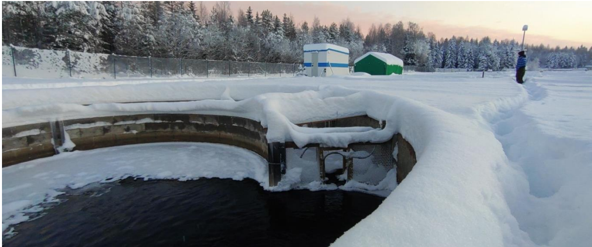
Kuva 5. Talviaikaiset olosuhteet koelaitaissa. Testialue (ns. rysä) jääkannen alla. Kokeen aikana veden virtaus altaisiin minimoitiin, jolloin myös suvanto-osaan muodostui nopeasti jääkansi.
