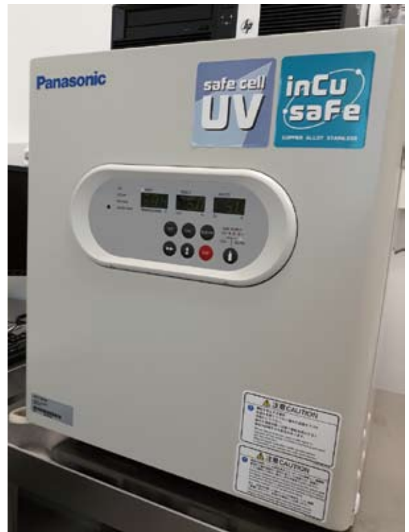
Inkubaattoria eli kasvatuskaappia Luken alkiolaboratoriossa tarvitaan munasolujen kypsyttämiseen ennen koeputkihedelmöitystä ja hedelmöitettyjen munasolujen eli alkioiden kasvatukseen pakastustai siirtokelpoiseksi. Inkubaattorin lämpötila pidetään 38.5°C:ssa. Kuva: Mervi Mutikainen
