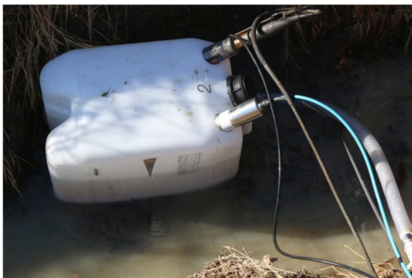
Kuva 43. Salaojamittausaseman kokoonpano. (Kuva Pasi Valkama)
