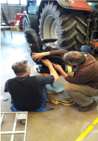
Kuva 1. Fysioakustiikkalaitteisto asennettiin traktorinistuimeen.
