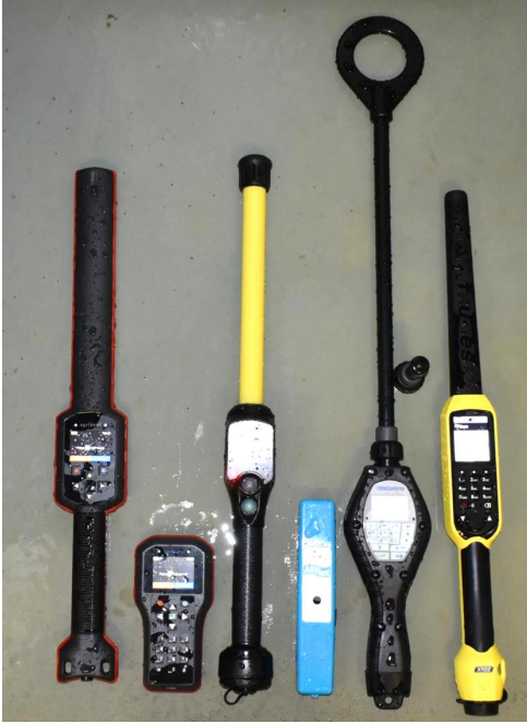
Kuva 14. Laitteet pestiin testin aikana useampaan kertaan juoksevan veden alla.
