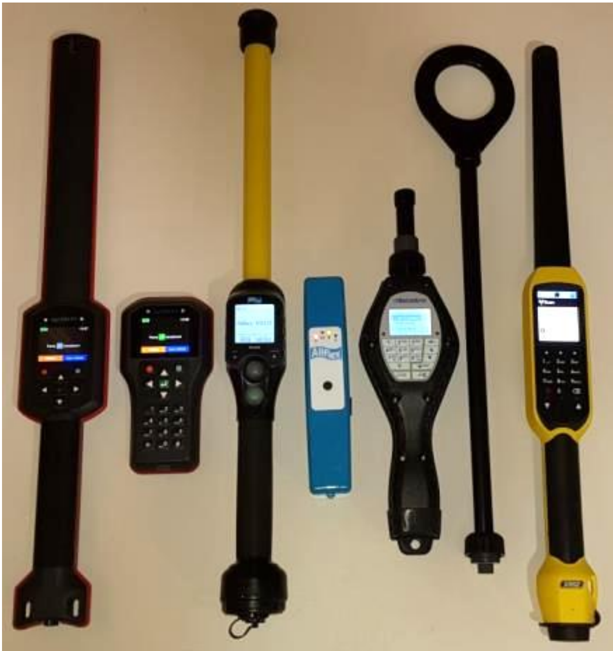
Kuva 10. Lukijalaitteet vasemmalta Agrident AWR 300, Agrident APR600, AllFlex RS420-80, Allflex LPR, BioControl HHR3000ProV2 lyhyellä antennilla ja vieressä pitkä antenni irrotettuna sekä TruTest XRS2.
