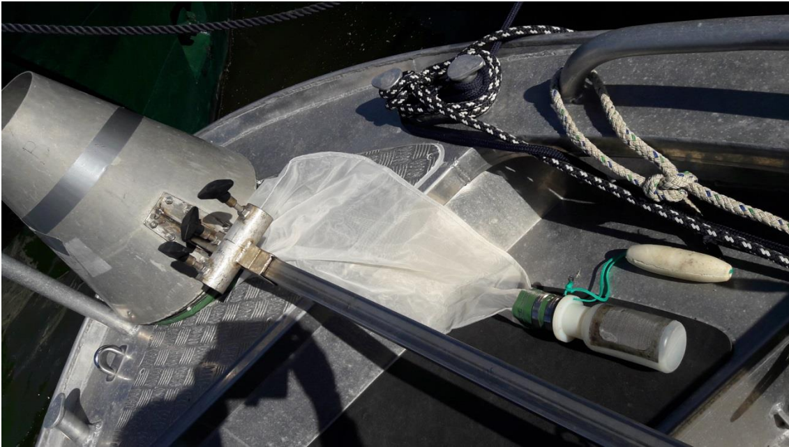
Kuva 13. Gulf-pyydyksen alumiinikartioon kiinnittyvä haavipyssi ja sihti-ikkunainen keräyspurkki. Kuva: Sanna Kuningas/Luke.
