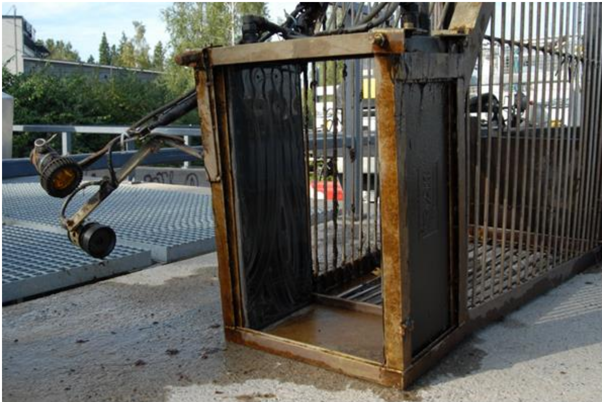
Kuva 11. Merikosken kalatien uloskäynnissä käytössä ollut Vaki-kalalaskurin laskuriyksikkö ja sen tueksi asennettu videokameralaitteisto valoineen. Lähde: Orell ym. (2014).
