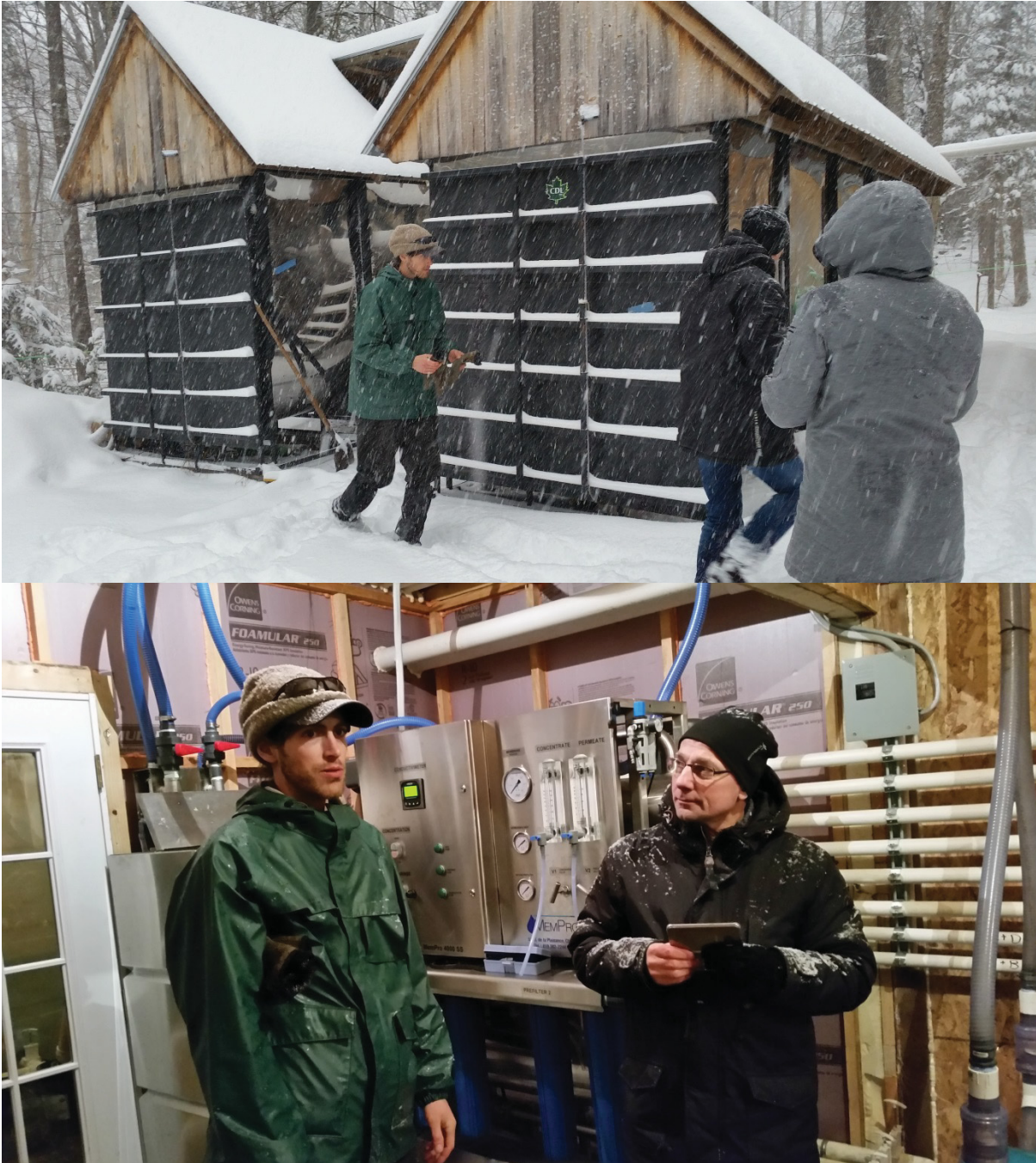
Kuva 7. Mahla johdetaan keruutilaan, jossa mahla UV- ja RO-käsitellään sekä hiekkasuodatetaan (Kuvat Jari Miina).
