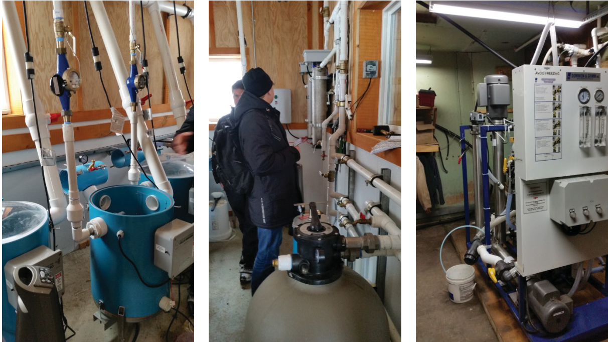
Kuva 14. Vasemmalla: Alipaineeseen perustuva mahan keruujärjestelmä näyttää monimutkaiselta. Keskellä: Mahla käsitellään UV-säteilyllä (taka-alalla) mikrobien vähentämiseksi ja hiekkasuodatetaan (etualalla). Oikealla: Mahlan sokeripitoisuutta kohotetaan ennen keittoa siirapiksi käänteisellä osmoosilla (Kuvat Jari Miina).
