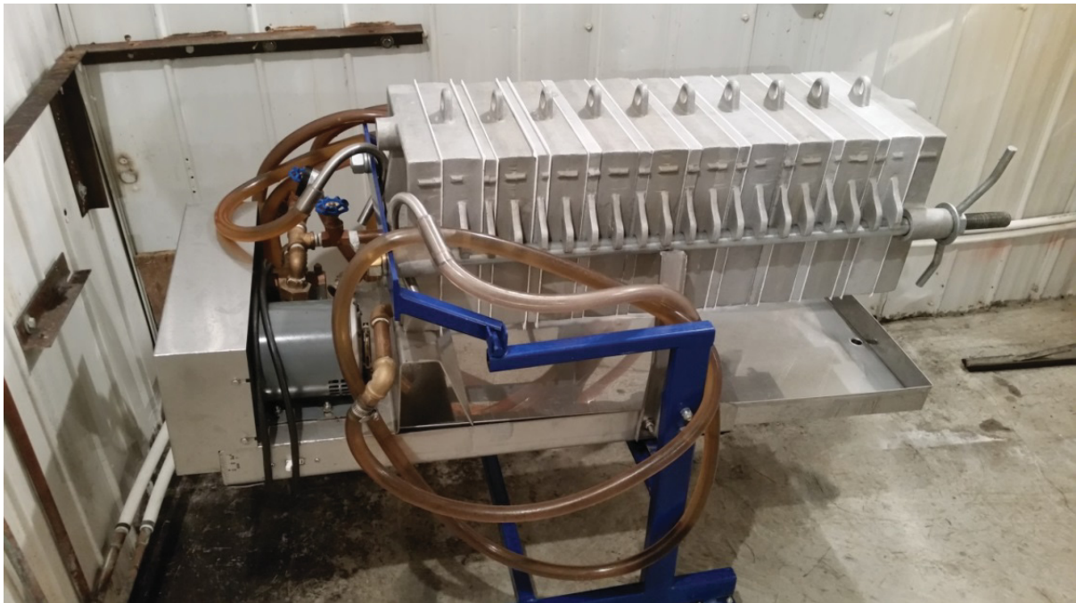
Kuva 24. Keitossa mahan kivennäisaineiden ja sokerin muodostamat 'kivet' poistetaan tällä laitteella (Kuva Jari Miina).
