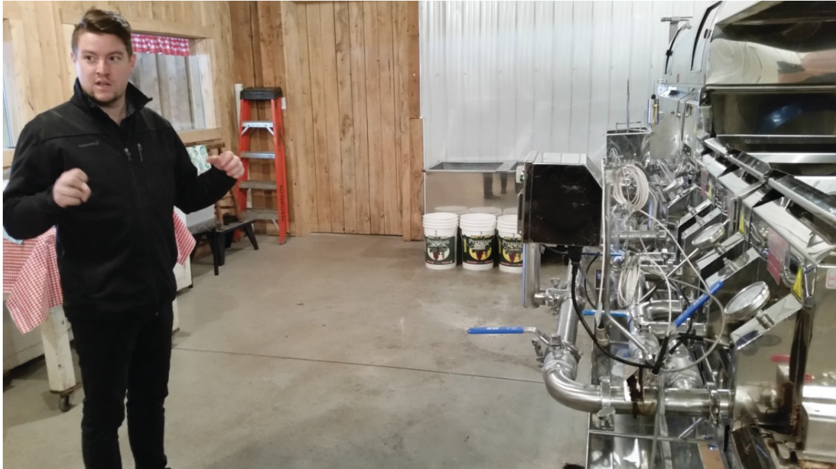
Kuva 23. Evaporaattori, jolla mahlasta haihdutetaan vettä pois ja tuloksena on siirappia (Kuva Jari Miina).
