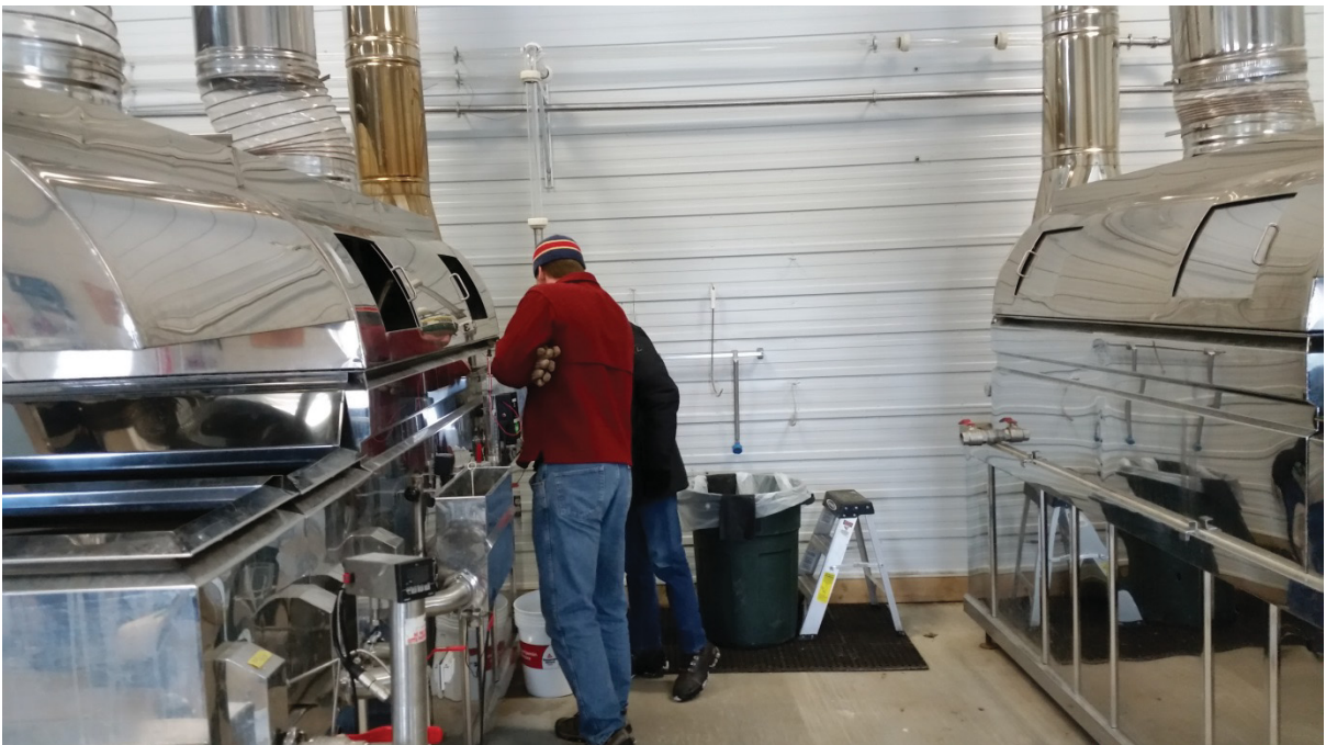
Kuva 4. Keittolaite, jolla käänteisellä osmoosilla tuotettu mahla käsitellään (Kuva Jari Miina).
