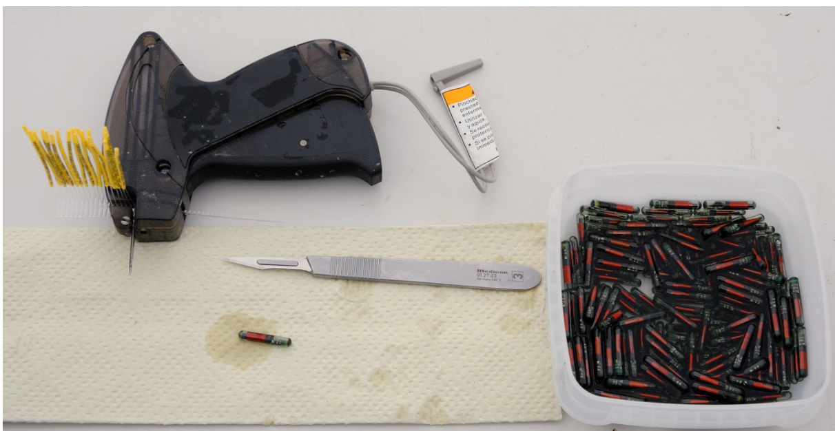
Kuva 4. Vuosina 2011–2012 toteutetussa PIT-merkintätutkimuksessa lohien vaelluspoikaset merkittiin sekä vatsaonteloon asennettavalla PIT-mikrosirulla että selkävän tyveen asennettavalla T-ankkurimerkillä. Kuva: Panu Orell.
