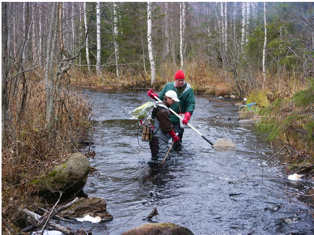
Kuva 2. Sähkökalastus on standardoitu menetelmä vesipuidedirektiivin mukaiseen kalaston näytteenottoon jokivesissä.
