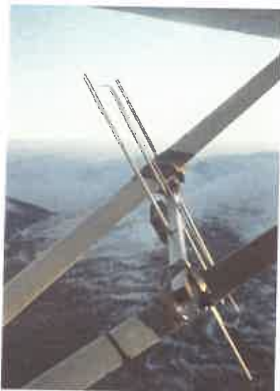
Kuva 11. Radiotelemetriatekniikka käytössä. Pienkoneen molemmille puolille siipistreevoihin kiinnitetyt yagi-antennit vastaanottavat maastosta kuuluvia radio-signaaleja jopa 60 km etäisyydeltä. Maaston muodot kuitenkin rajoittavat signaalien kuuluvuutta. Taustalla Saariselän tunturialuetta syystalvella 1997.
