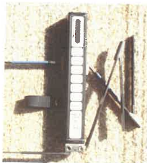
Kuva 12. Televilt RX 8910 –radiovastaanotin soveltuu radiopeilaukseen sekä lentokoneesta käsin että maastossa. Vastaanottimen herkkyys on hyvä lähietäisyyksillä kohdetta paikannettaessa.
