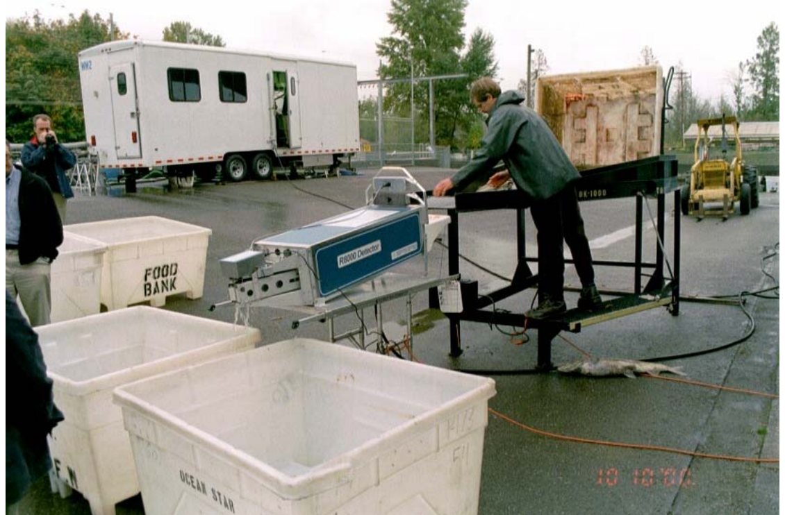
Kuva 3. Kuonumerkkien etsintää kuningaslohista NMTn hihnadetektorilla. Maassa lojuva iso lohi (10–15 kg) ei mahtunut tästä detektorista läpi. Taustalla merkintävaunu, jossa oli käynnissä kuonumerkintä automaattisella kuonumerkintälaitteella.
