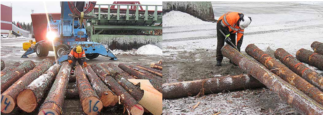
Kuva 3. Koetyvitukit numeroitiin ja latvapäähän kiinnitettiin ketju ja koukkuvaaka upotusmittausta varten (vas.). Upotusmittauksen jälkeen koetyvitukit mitattiin saksimittauksella (oik.) (kuvat: Jari Lindblad).
