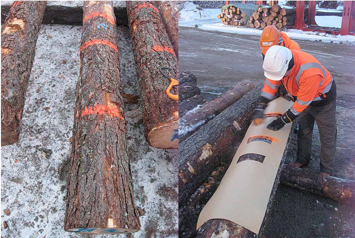
Kuva 2. Koetyvitukkeihin maalattiin sabluunan avulla upotussyvydet 50, 100 ja 130 senttimetrin etäisyyksille kaotosahauksesta (kuvat: Jari Lindblad).
