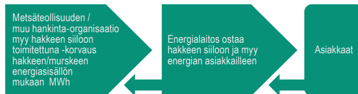
Kuva 5. Arvoverkko 2: Energialaitos ostaa hakkeen siiloon (Pelli 2010).
