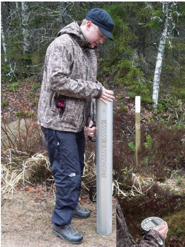
Kuva 1.1. Loadman II pudotuspainolaite ja koeala 6 kivennäismaa (Kuva: Jari Ilomäki 2010).
