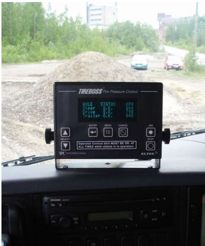
Kuva 3.2. CTI-laitteistoa käytetään suoraan ohjaamosta. Ohjaus-, veto- ja perävaunuakseille määritellään omat akselipainoa ja ajonopeutta vastaavat rengaspaineet (Kuva: Tomi Kaakkurivaara 2009).
