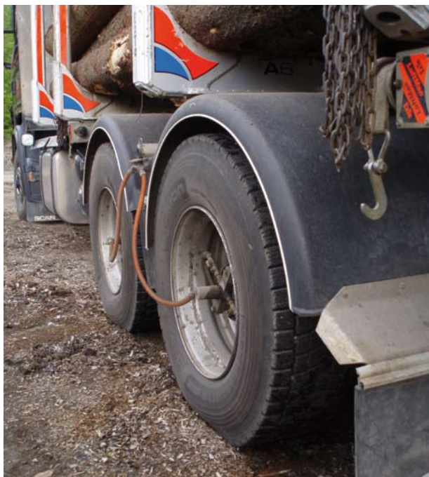
Kuva 3.3. Kompressorilta tuleva ilma ohjataan vetoakseleitten renkaile ulkokautta ja muille renkaile akseleita pitkin (Kuva: Tomi Kaakkurivaara 2009).
