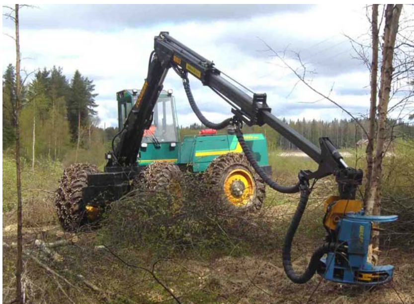
Kuva 6. Koneellinen hakkuutyö ja puiden joukkokäsittely edustavat nykyaikaista energiapuun hankintaa. Kuva Jussi Laurila.
