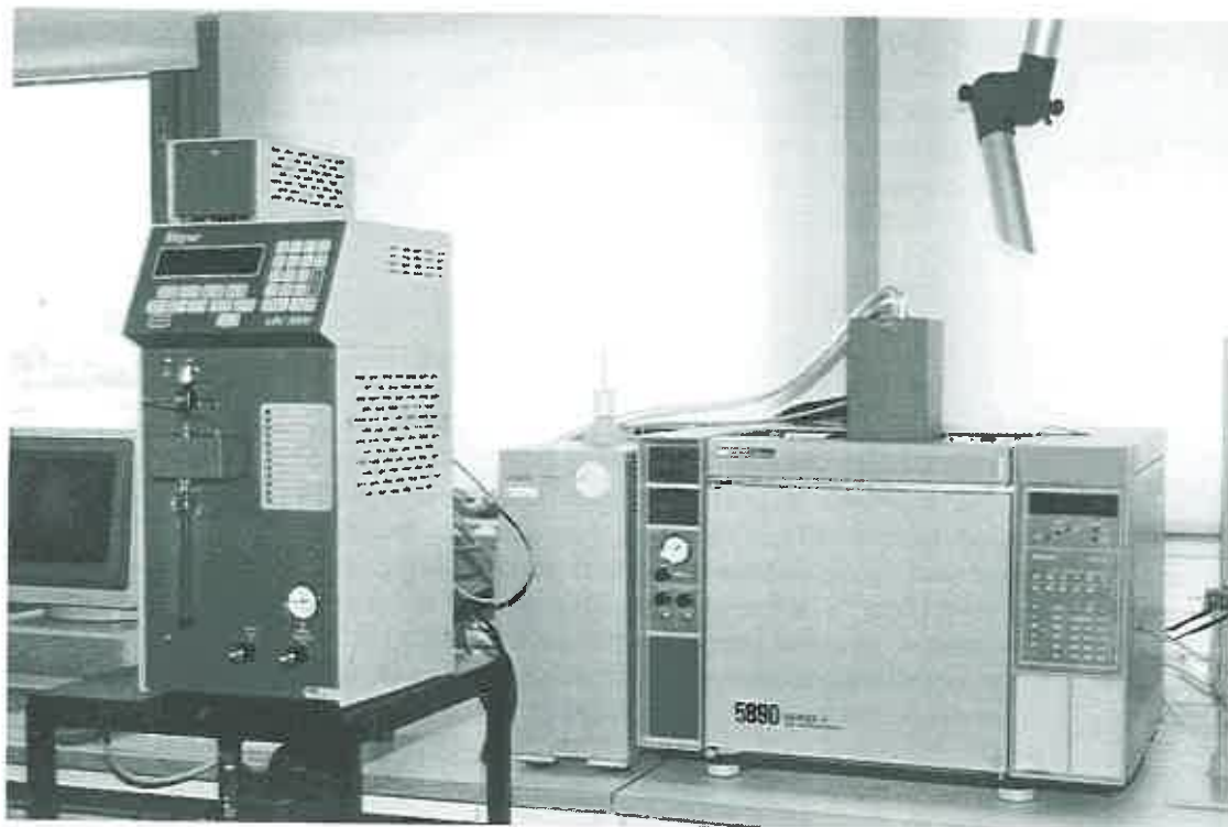
Kuva 1. Haju- ja makuhaitta-aineiden tutkimuksessa käytetty laitteisto: GC/FTIR varustettuna purge & trap-näytteenkäsittelysystemillä. Kaasukromatografian oikeasta sivusta tulevaan kolonniin liitetään lasisuppilo, josta eluivat yhdisteet haistellaan tai yhdisteet kerätään pieniin öljypulloihin makuarviointia varten.
