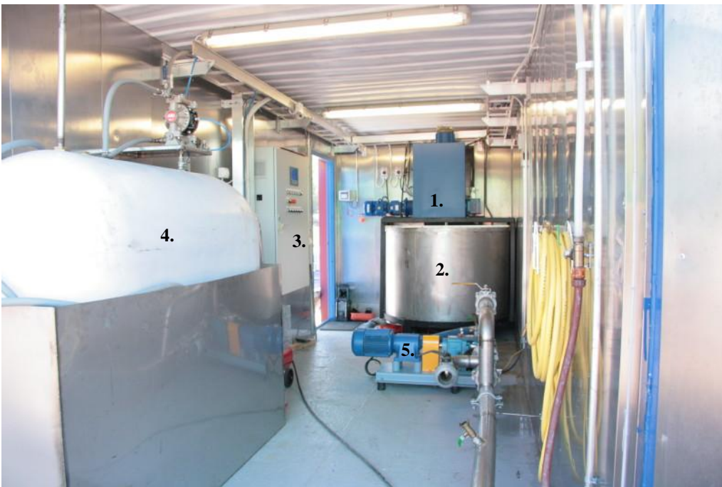
Kuva 38. Havainnekuva hapotuskontin sisältä: 1 = murskain, 2 = sekoitussäiliö, 3 = ohjausyksikkö, 4 = happosäiliö ja 5 = pumppu. (Kuva. Klaus Berglund).
