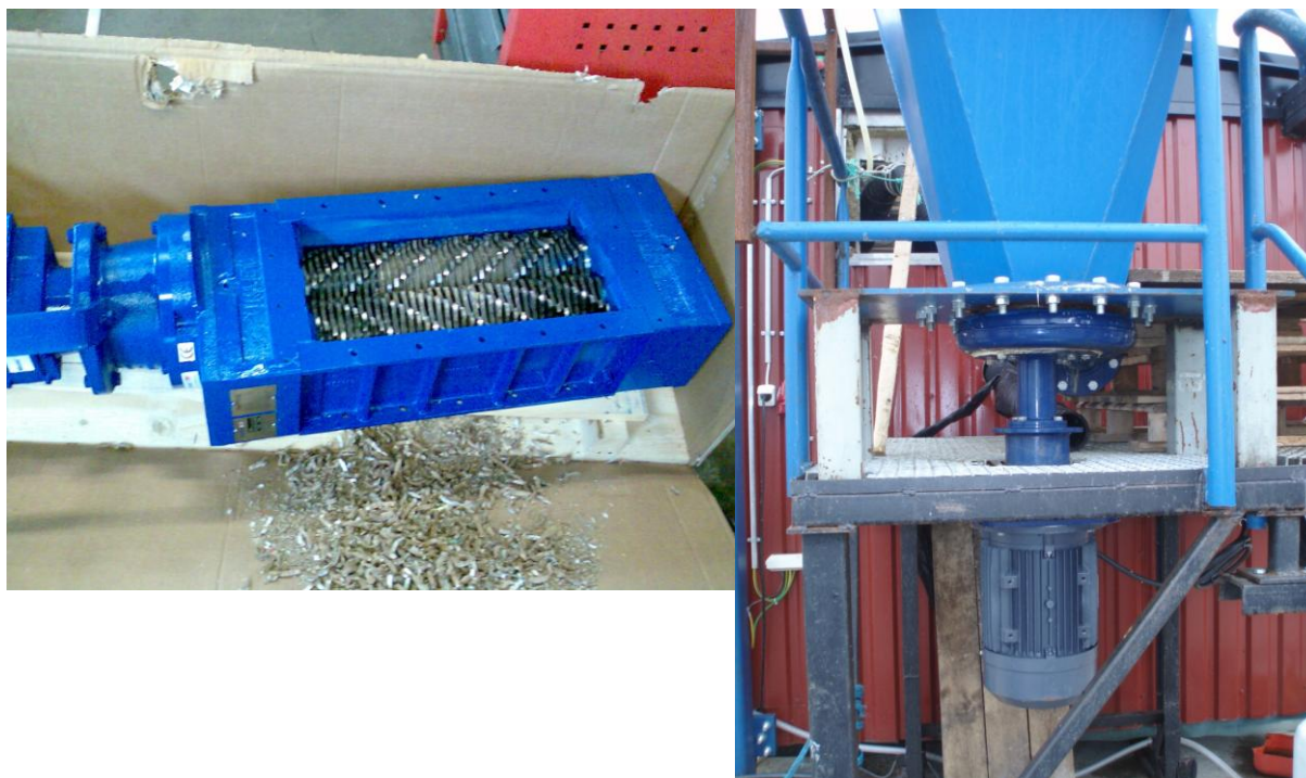
Kuva 40. Vasemmalla tehon murskainmalli ja oikealla tehokas uppopumppumalli (Kuvat: Jari Setälä ja Klaus Berglund).
